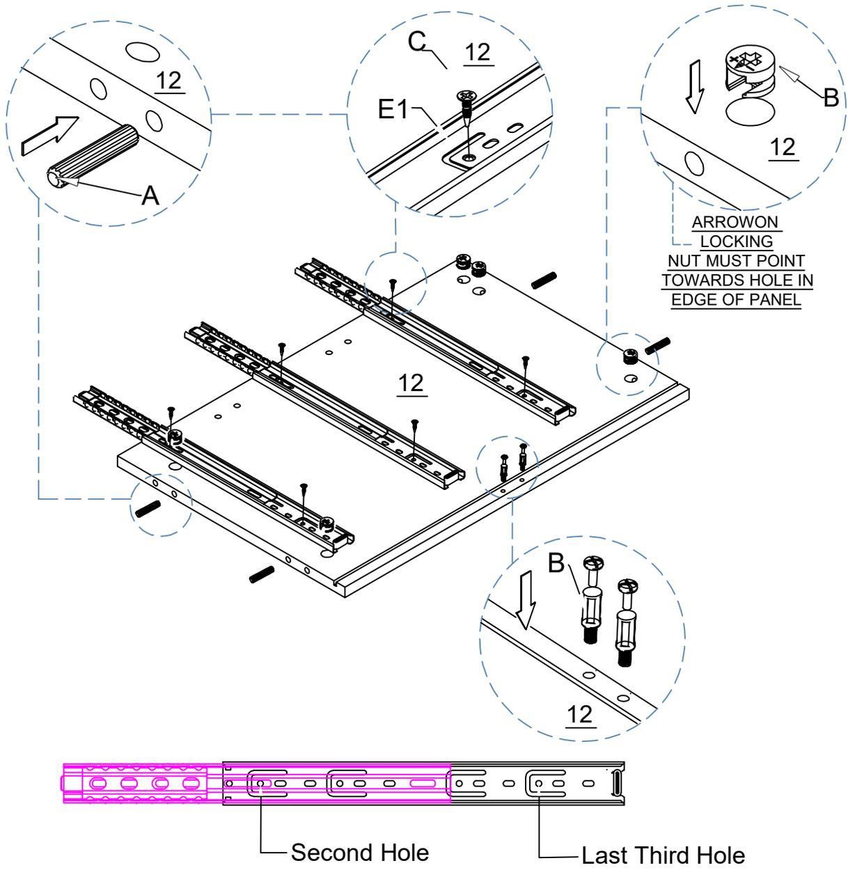
**SCREW MUST BE INSERTED
