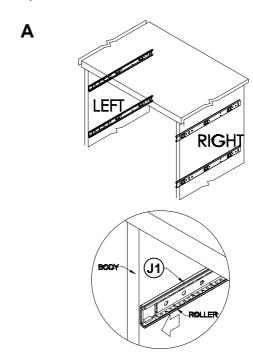
• PUSH THE ROLLER OF J1 TO THE FRONT SIDE OF THE BODY.
