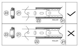
ALIGN Z2 ON LEFT & RIGHT TO Z1 AT THE CORRECT POSITION.
