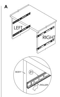
• PUSH THE ROLLER OF Z1 TO THE FRONT SIDE OF THE BODY.
