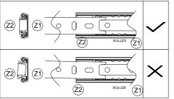
ALIGN Z2 ON LEFT & RIGHT TO Z1 AT THE CORRECT POSITION.
