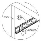
PUSH THE ROLLER OF Z1 TO THE FRONT SIDE OF THE BODY.
